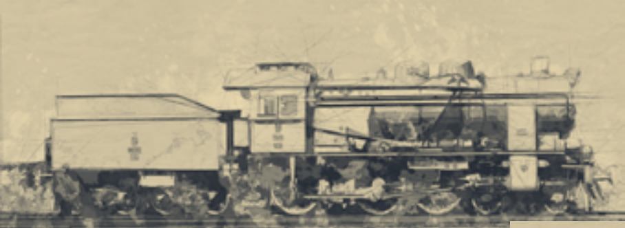
Pierwszy polski parowóz osobowy Ok22 produkowany od 1923 r. w fabryce lokomotyw Fablok w Chrzanowie. Ryc. Karolina Masłowska
