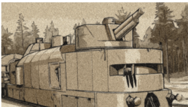
Rysunek 8. Jeden z nowych wagonów artyleryjskich „Śmiałego” z widocznymi wysuwanymi drzwiami i umieszczonymi w nich ciężkimi karabinami maszynowymi (1939 rok)
