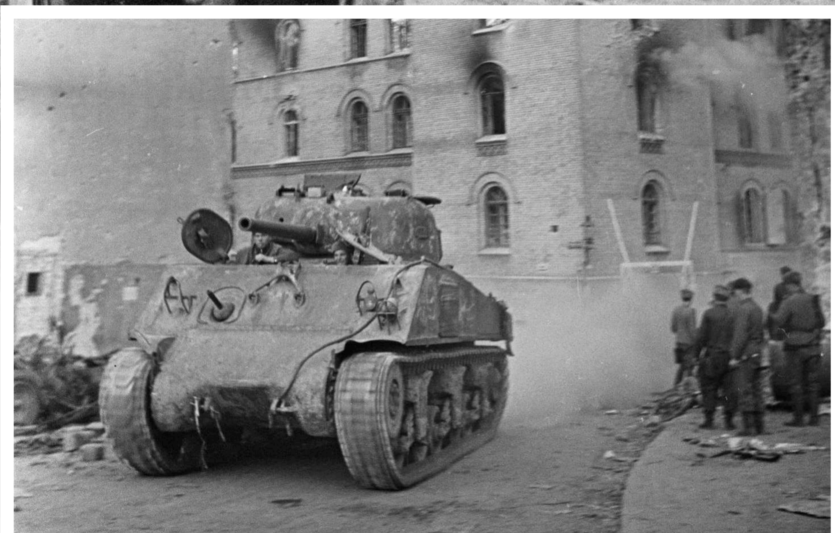
Czołg M4A2 Sherman z lend lease'u w służbie Armii Czerwonej (fot. A. Szajchet, MIIWŚ).
